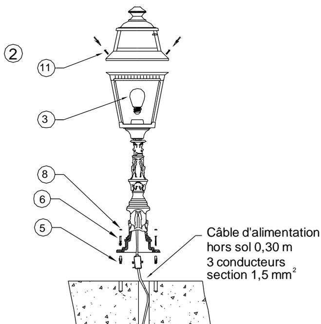
**ATTENTION :** - Cet appareil doit être raccordé à la terre
